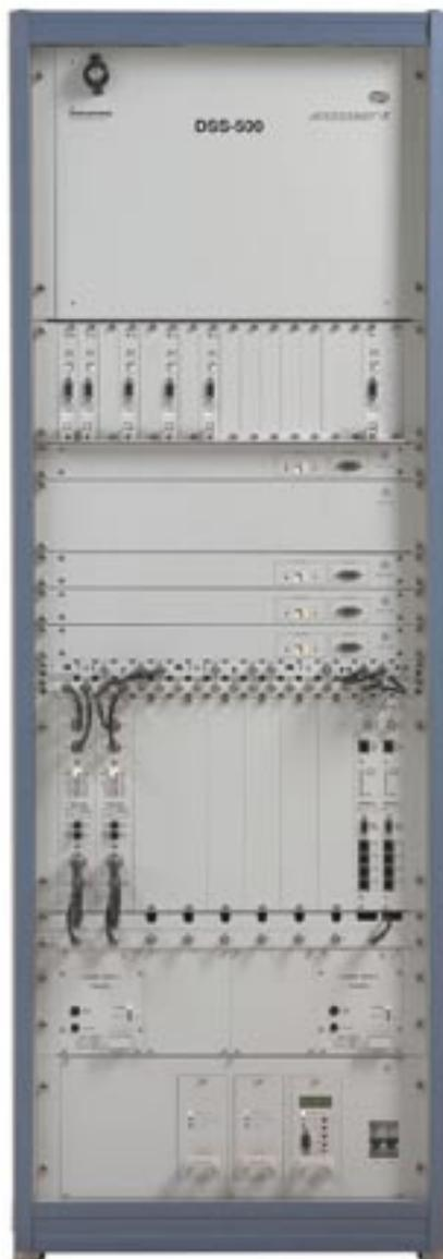
DSS-500 представляет собой систему TETRA для автономной ячейки, объединяющую функции базовой станции и коммутатора и допускающую подключение к городским и офисным АТС и ко всем диспетчерам.
